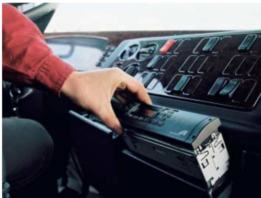
35. ábra: Az autórádió méretű Toll Collect készülék beépítése [35]
